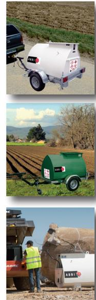
**"Compacte et mobile, l'Abbi routière est le GRV qui vous permet d'aller ravitailler en toute autonomie vos engins sur vos différents chantiers. L'Abbi routière répond également à votre souci de protection de l'environnement grâce à sa rétention intégrée de 110 %.**
