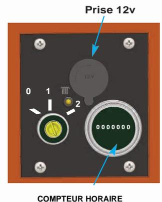
*Ne pas tenter de lancer le démarrage pendant plus de 20 secondes de suite. Attendre une minute avant de réessayer. Rechercher la raison du non-démarrage.*
