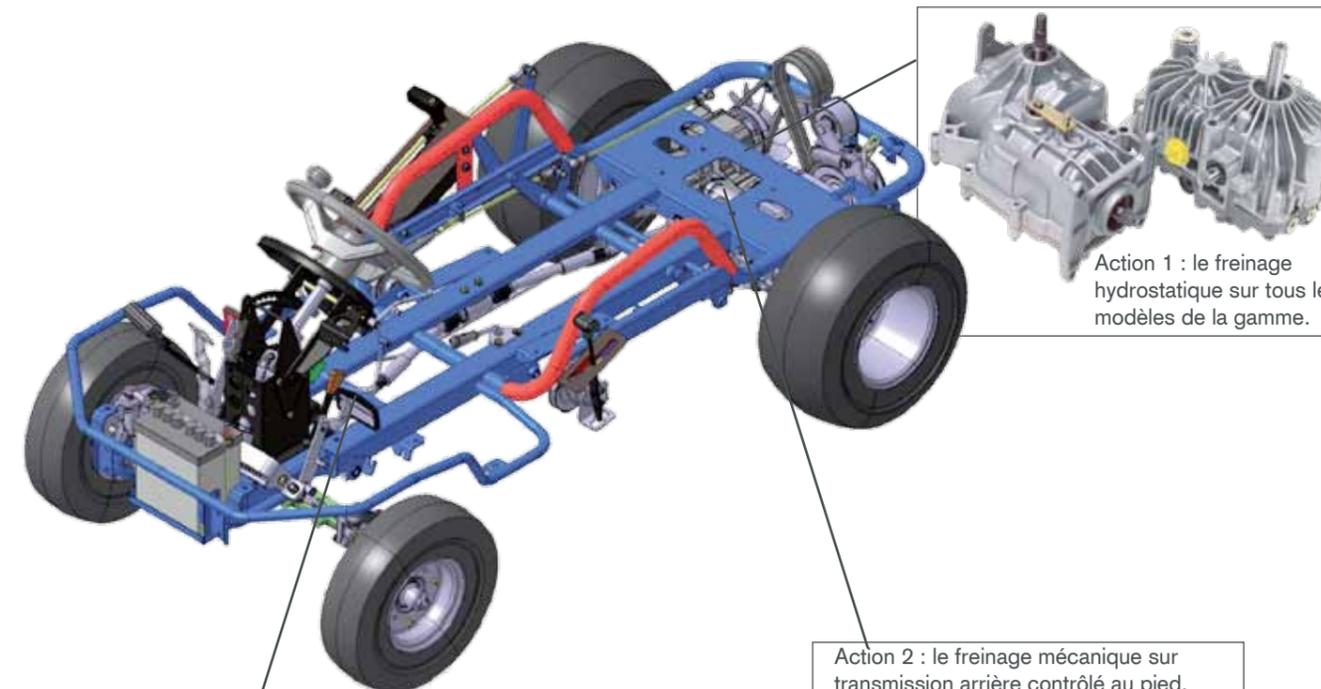
Action 1 : le freinage hydrostatique sur tous les modèles de la gamme.
