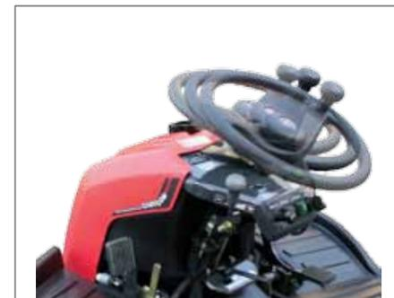
Volant et poste de conduite réglables en hauteur et en inclinaison.
