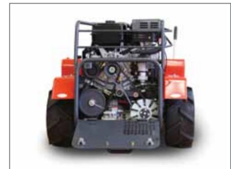
La conception basse du châssis associée aux 4 roues motrices permet de grimper sur des pentes de 25° en frontal ou 30° en latéral.
