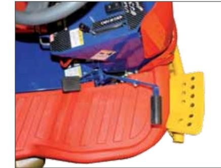
Réglage de hauteur de coupe facile et pratique : le levier, ergonomique, est réactif grâce à son ressort de rappel.
