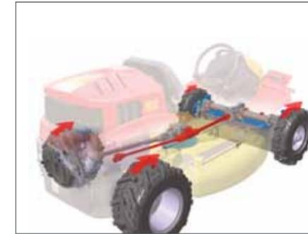
2 vitesses d'avancement : RAPIDE jusqu'à 13,8 km/h et LENTE jusqu'à 7,7 km/h en opération.
